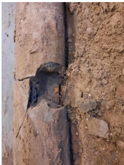
Figuur 4-6. Zandinsluiting (links) gedetecteerd tijdens het VSP-DAP onderzoek (Pauw en Obando 2022). In de meting is deze te herkennen aan de afname van de magnetische susceptibiliteit op een diepte van ~1.2 m.
